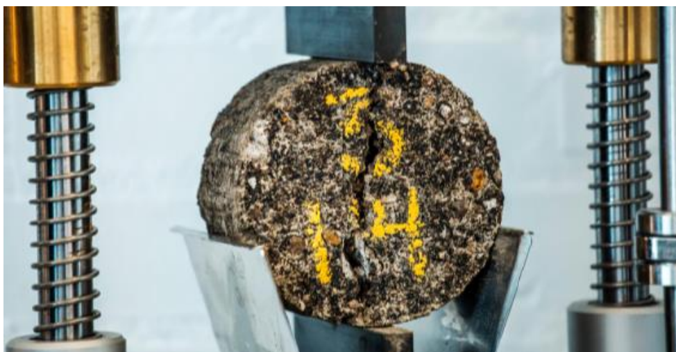
Fig. 5.4.1: Spaltetrækstyrkebestemmelse af Marshall-indstampet prøvelegeme.
