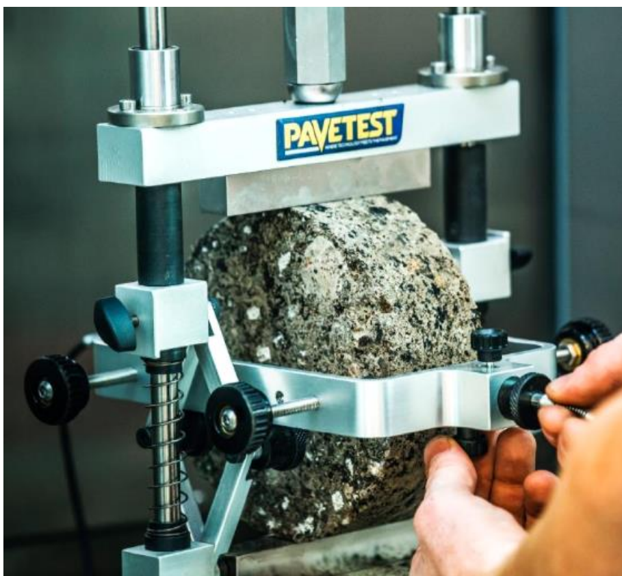
Fig. 5.5.1: Opstilling til stivhedsmodul-bestemmelse med hydraulisk DTS-30 testudstyr fra Pavetest
