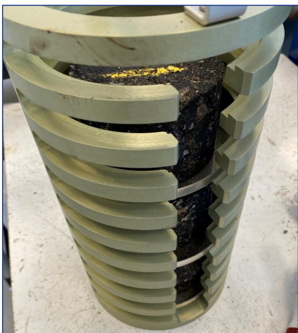
Foto 5.2.1: De 3 Marshall-legemer monteret i rack. Foto 5.2.2: Rack'en placeres under låg i PAV-ovn.
