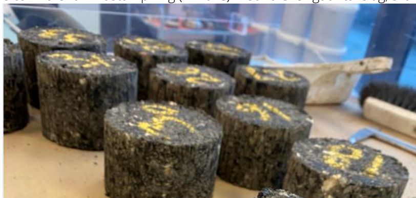
Fig. 5.3.2: BSM-materialet fra 22/9 er indstampet ved forskellige slagenergier.
