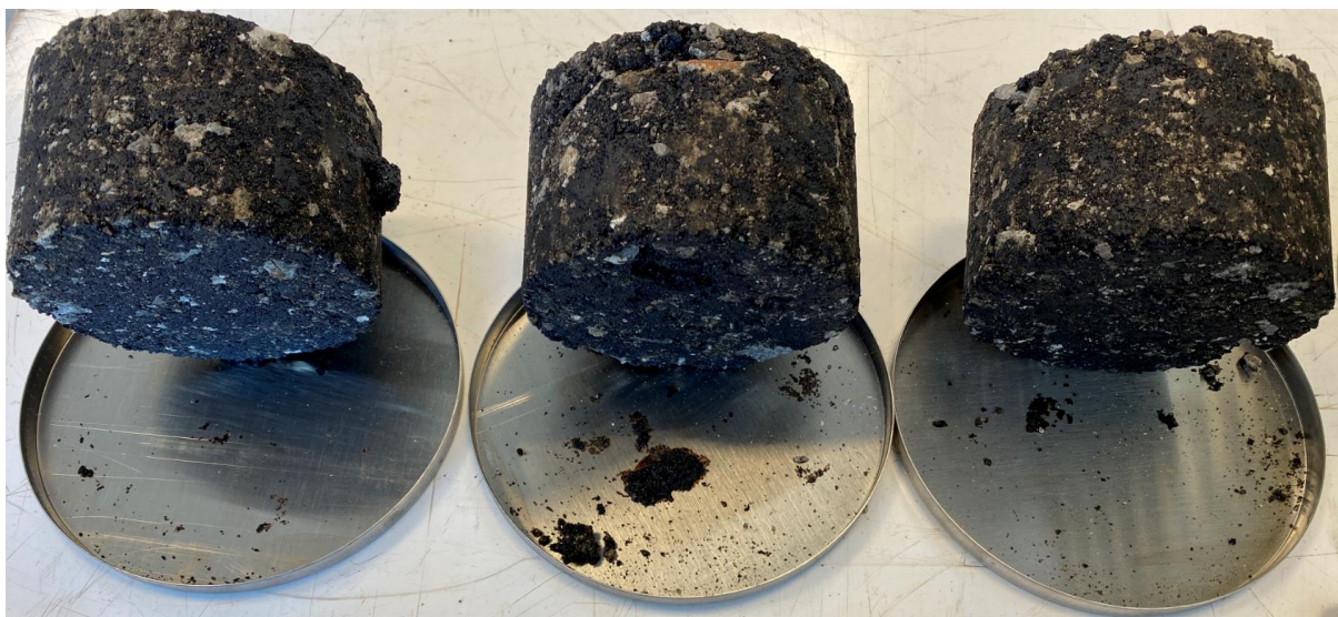
Foto 5.2.3: De tre Marshall-legemer efter afsluttet PAV-langtidshærdning. Kun den midterste af de tre kerner har vist marginalt bitumenafløb trods opvarmning til 90 °C i 20 timer under tryk.
