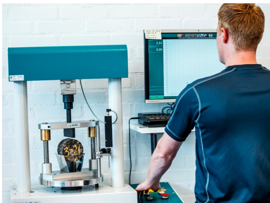
Foto 3.4.2: Spaltetrækstyrkebestemmelse til vurdering af vandfølsomhed.
