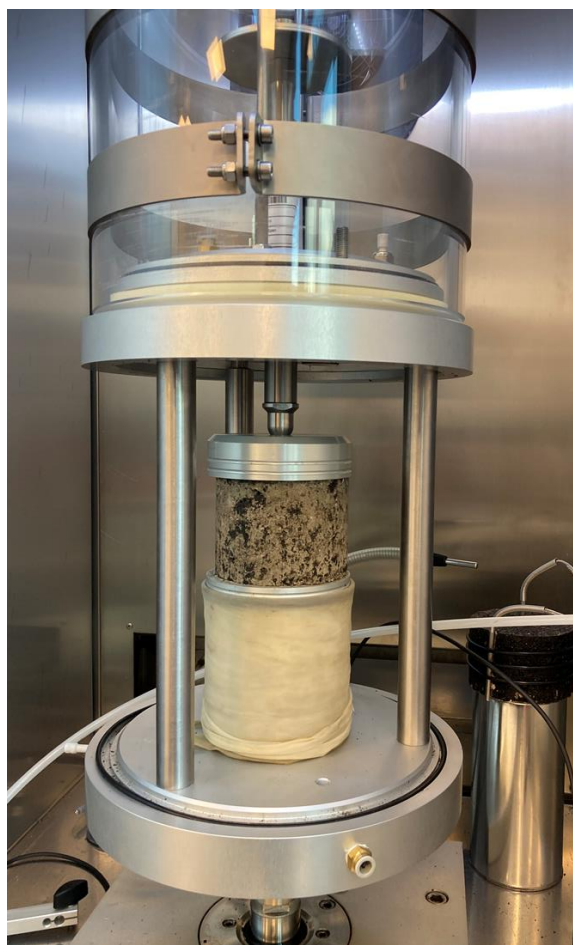
Fig. 5.2.2: Montering af BSM-legeme i triaxial-celle
