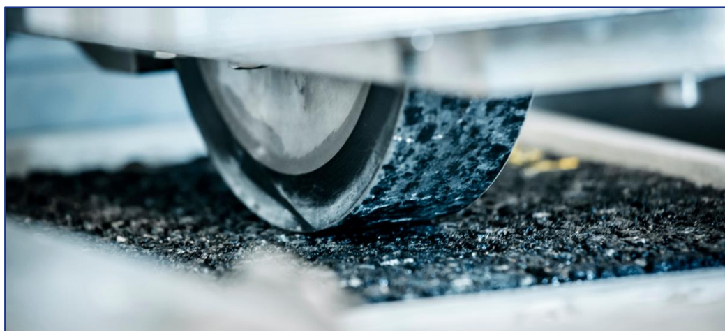
Foto 5.1.1: Sporkøringsforsøget udføres med fastgummihjul og 10.000 dobbeltpassager ved 45°C, som antages at være den højeste temperatur, som et asfaltbærelag under danske klimaforhold udsættes for. Belastningstrykket svarer omtrentligt til en lastbils.
