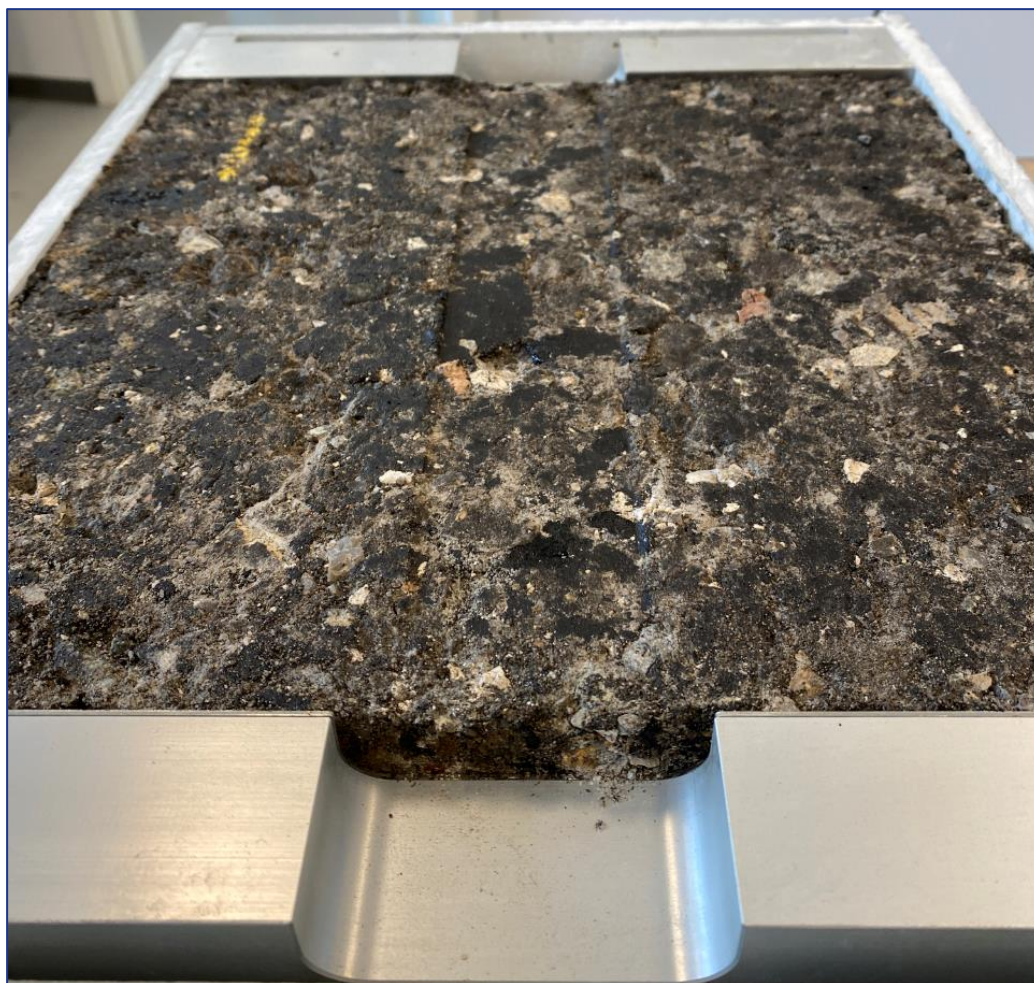
Foto 5.1.2 Sporkøringsplade efter endt test. Sporet er knapt nok synligt, trods 10 cm lagtykkelse.
