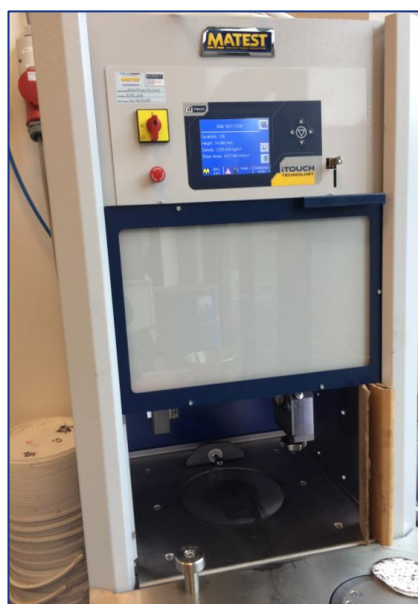
Fig. 5.3.5: Gyrator, klar til montering af prøvelegeme
