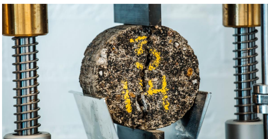
Foto 3.4.3: Close-up af spaltetrækbrud. Den lodretgående brudlinje ses tydeligt.
