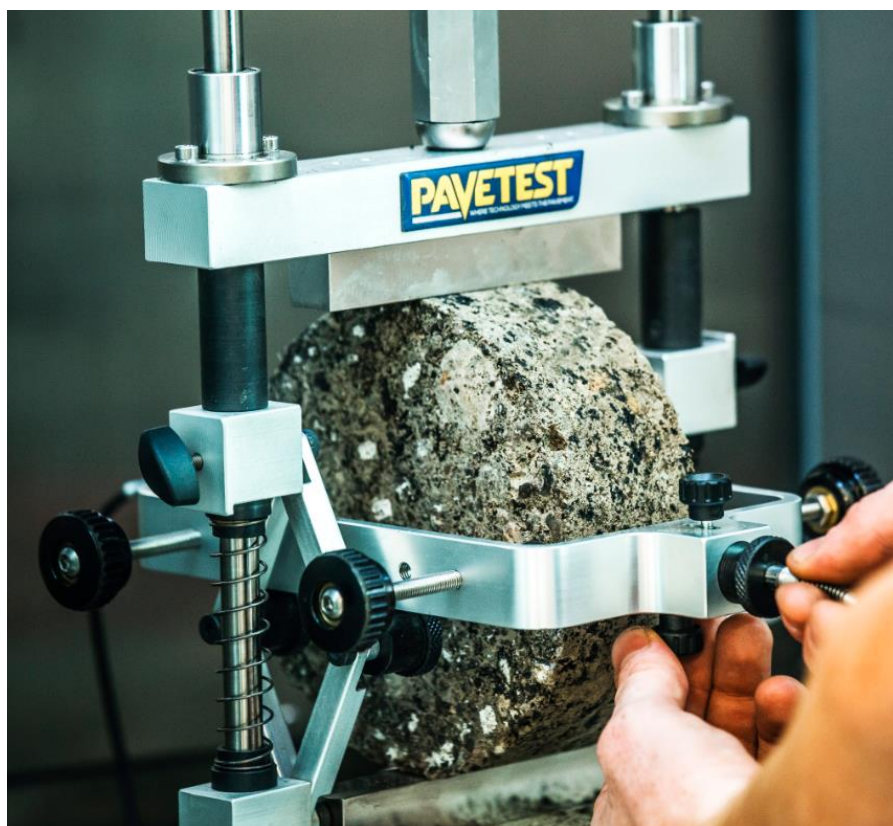
Foto 3.5.1: Opstilling til stivhedsmodul-bestemmelse med hydraulisk DTS-30 testudstyr fra Pavetest.
