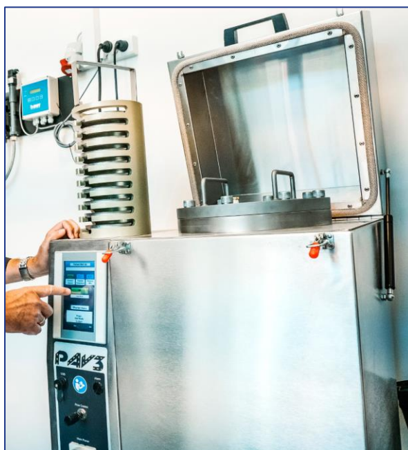
Foto 5.2.1: De 3 Marshall-legemer monteret i rack. Foto 5.2.2: Rack'en placeres under låg i PAV-ovn.
