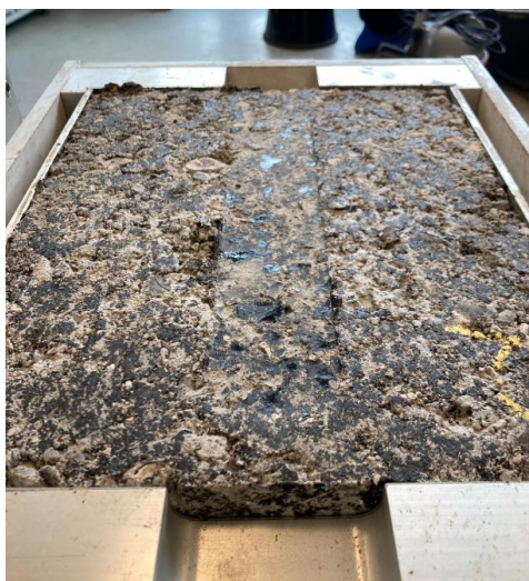
Fig. 4.7.2: Trods en pladetykkelse på 10 cm er der stort set ikke opstået synlig sporkøring.
