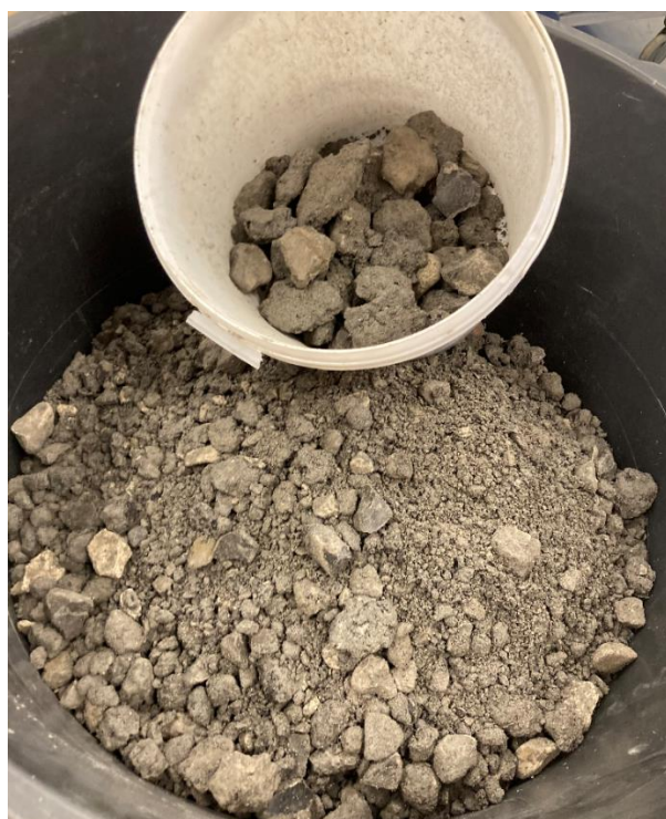
Fig. 4.1.2: Før sigtning og indstamping af prøvelegemer blev større overkorn (visuelt > 64 mm) frasorteret (hvide spand øverst i billedet).
