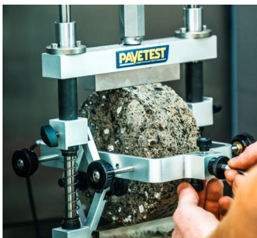
Fig. 4.6.1: Opstilling til stivhedsmodul-bestemmelse (arkivfoto).
