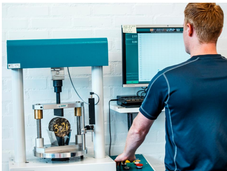
Fig. 4.5.2: Spaltetrækstyrkebestemmelse til vurdering af vandfølsomhed (arkivfoto).
