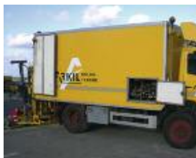
SonicSampDrill er monteret bag på en af Arkil's lastbiler.
