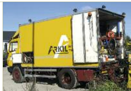
Sonicrig monteret på 4 x 4 lastvogn.
