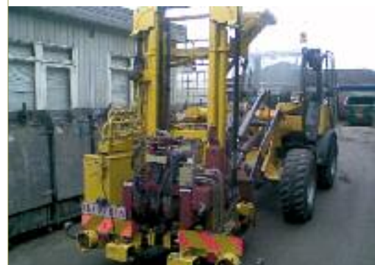
Sonicrig monteret på gummihjulslæsser.
