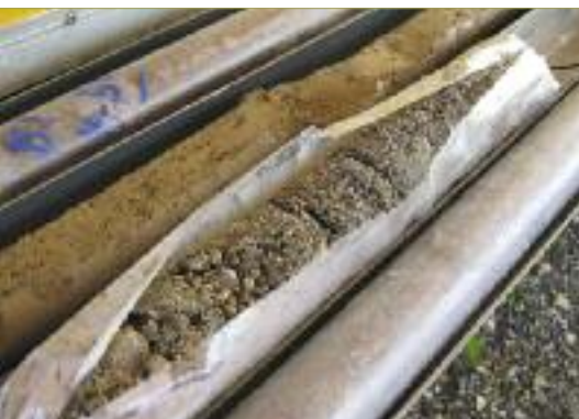
Eksempler på kerneprøver i halvskål, rialsanposer og i lukkede akrylrør.
